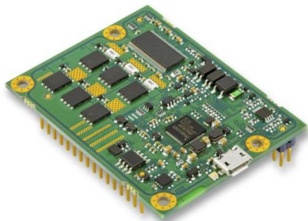
EPOS4 Module 50/8 (59.5 x 46.0 x 14.1 mm) OEM 位置控制器模組，專為不超過 400/1500 W 並 附有編碼器的有刷 DC 馬達，以及附有霍爾感應器 和編碼器的無刷 EC 馬達設計。 © 2016 maxon motor
