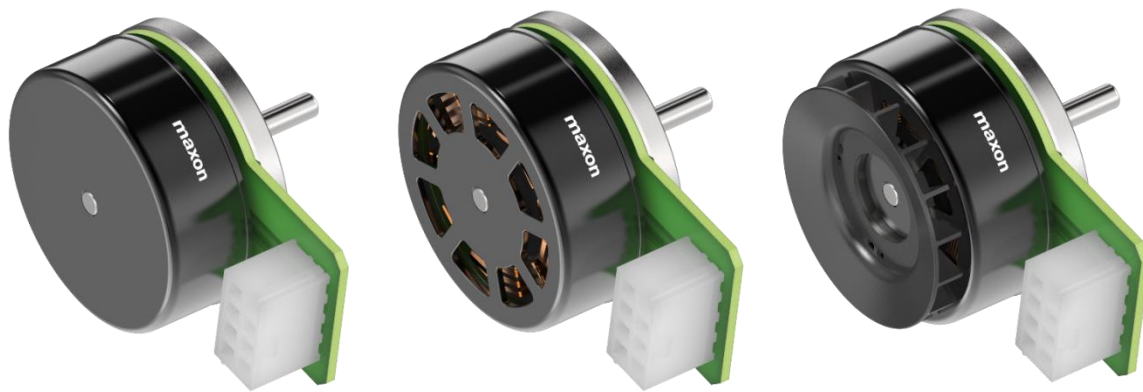
maxon EC 45 flat：標準版本 (50/ 70 W) – 開放式轉子 (60 / 80 W) 和具有最佳散熱特性的風扇版本 (90/ 120 W) – 從左到右。
